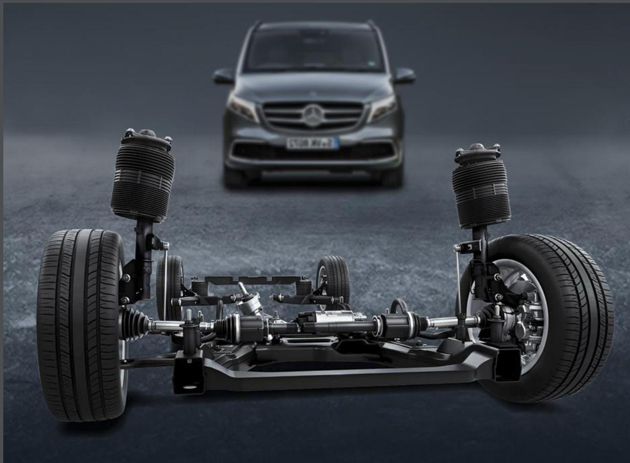
**Замена пружин подвески на пневматические подушки поможет сделать Ваши путешествия более комфортными.**
